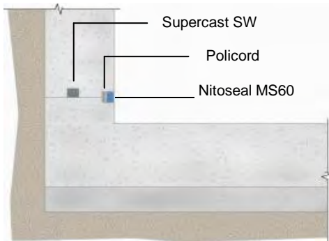
② Junta elevada
